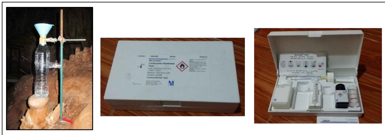
รูปที่ 5-2 การเก็บตัวอย่างหยดน้ำไว้ในขวดพลาสติกสะอาด (ซ้าย) ชุดทดสอบค่าความเข้มข้นของ \text{CaCO}_3 อย่างง่าย (กลางและขวา)
