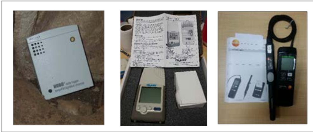
รูปที่ 5-1 เครื่องบันทึกอุณหภูมิและความชื้นสัมพัทธ์แบบอัตโนมัติ (ซ้าย) และอุปกรณ์วัดค่าระดับ CO 2 ในอากาศแบบอัตโนมัติ (กลาง) อุปกรณ์วัดค่าระดับ CO 2 ในอากาศแบบมือถือ (ขวา)
